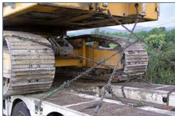
Fig. 39. Excavadora con una fijación oblicua por cadenas.
