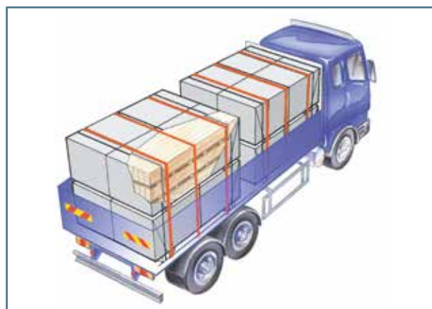
Fig. 51. Carga completa de tablones fijada.
