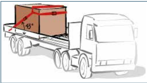
Fig. 26. Ejemplo de fijación anti-rebote que impide el desplazamiento hacia adelante.
